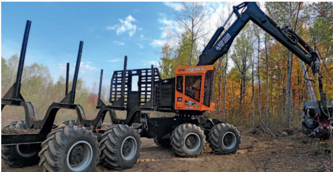
Le combiné abatteur-porteur, un concept «deux en un».
