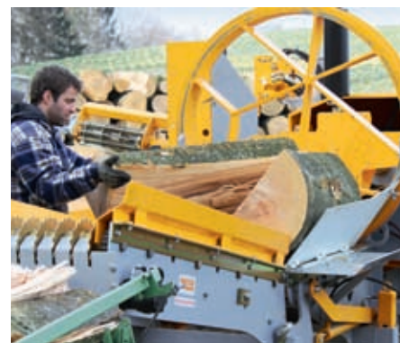
En haut, une fendeuse combinée à couteau rotatif et table de nettoyage (devant). Ces engins sont homologués pour la route et peuvent circuler sur de grandes distances, à l'exemple de la Roto 66 G09 D105 ci-dessous.
