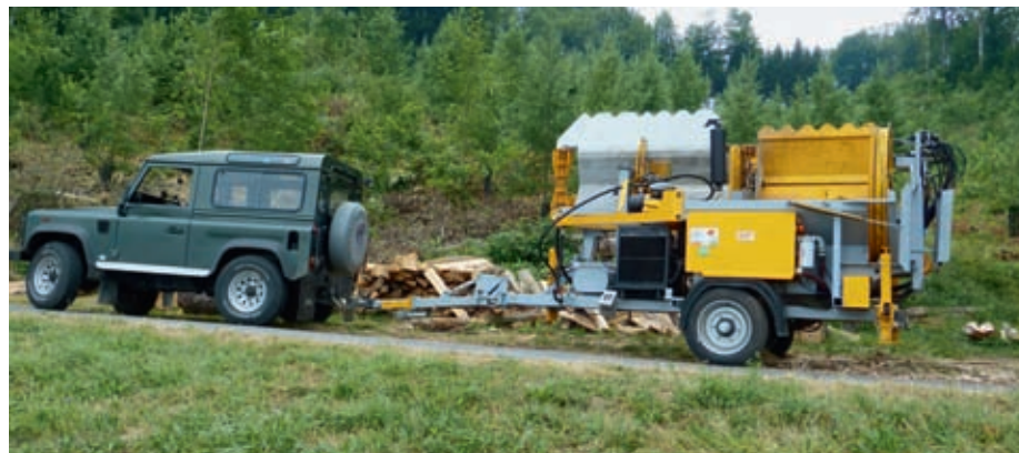
En haut, une fendeuse combinée à couteau rotatif et table de nettoyage (devant). Ces engins sont homologués pour la route et peuvent circuler sur de grandes distances, à l'exemple de la Roto 66 G09 D105 ci-dessous.
