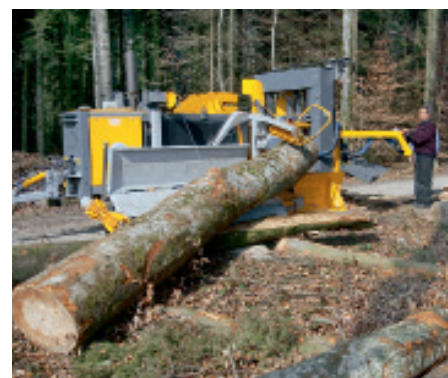
Mit Hilfe der Seilwinde am FM 816 wird ein Stamm auf das Förderband des Spalters gehoben.
