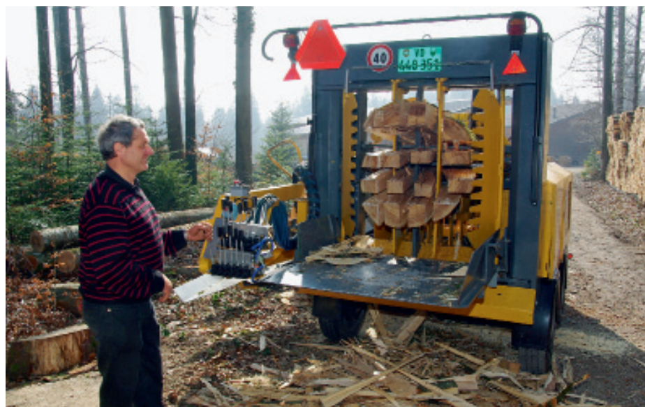
Afcor-Gründer Dominique Cornu präsentiert den FM 816, seinen stärksten Sägespalter mit 43 t Spaltkraft. Mit dem Spaltkreuz für 16 Scheite kann er die Maschine mit bis zu 60 cm dicken Stämmen beschicken.
