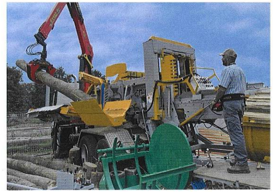
Links: Der Aficor Roto 66 ist mit einem drehbaren Spaltmesser ausgestattet. Rechts und unten rechts: Beim Aficor FM 816 lassen sich die horizontalen und vertikalen Spaltmesser hydraulisch verstellen.
