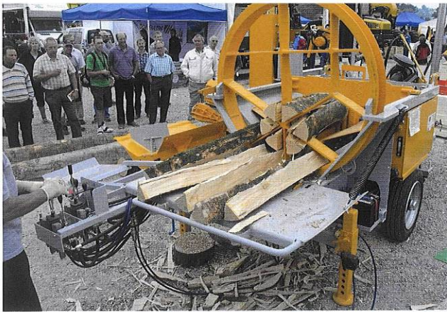
Links: Der Aficor Roto 66 ist mit einem drehbaren Spaltmesser ausgestattet. Rechts und unten rechts: Beim Aficor FM 816 lassen sich die horizontalen und vertikalen Spaltmesser hydraulisch verstellen.
