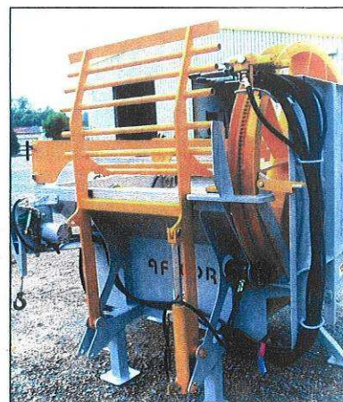
La FM 66 roto en position repliée pour le transport
