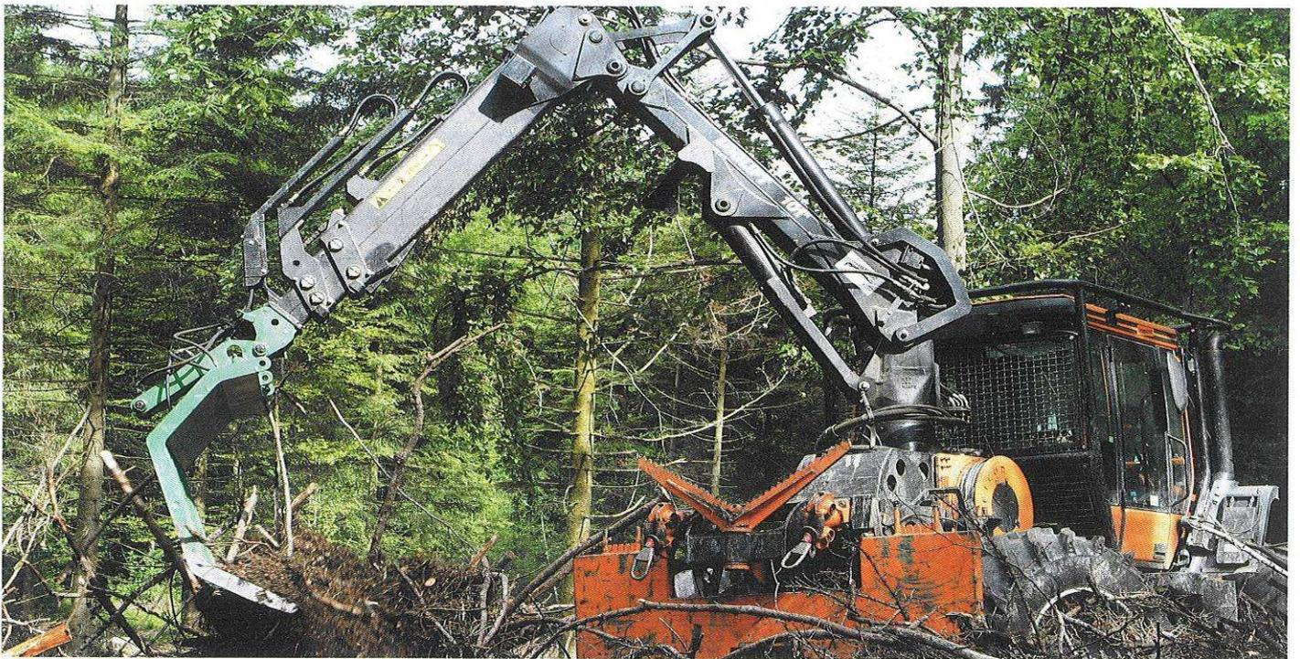
Ce tracteur agricole (conduit par la forestier-bûcheron-débardeur Guy Clerc dans les forêts lausannoises) a été spécialement adapté pour des travaux forestiers spécifiques. Dominique Cornu a ajouté au modèle d'origine (un Doppstadt) une bêche et un treuil hydrauliques, un râtelier à branches et un pose-grumes...
