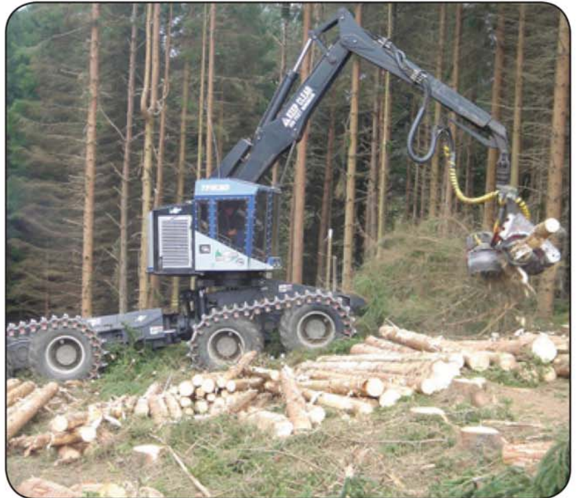
TimberPro TB 830 avec option de tilt 22°, grue abateuse tracks et tête Quadco
