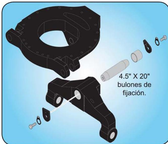
Système de boulons d'anclage plus longs qui assurent une longue vie, performance et une plus facile maintenance.
