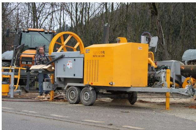
Fendeur moins de 3.5 tonnes pour atteler à un véhicule léger.
