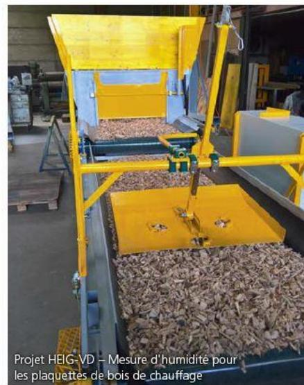
Projet HEIG-VD – Mesure d'humidité pour les plaquettes de bois de chauffage
